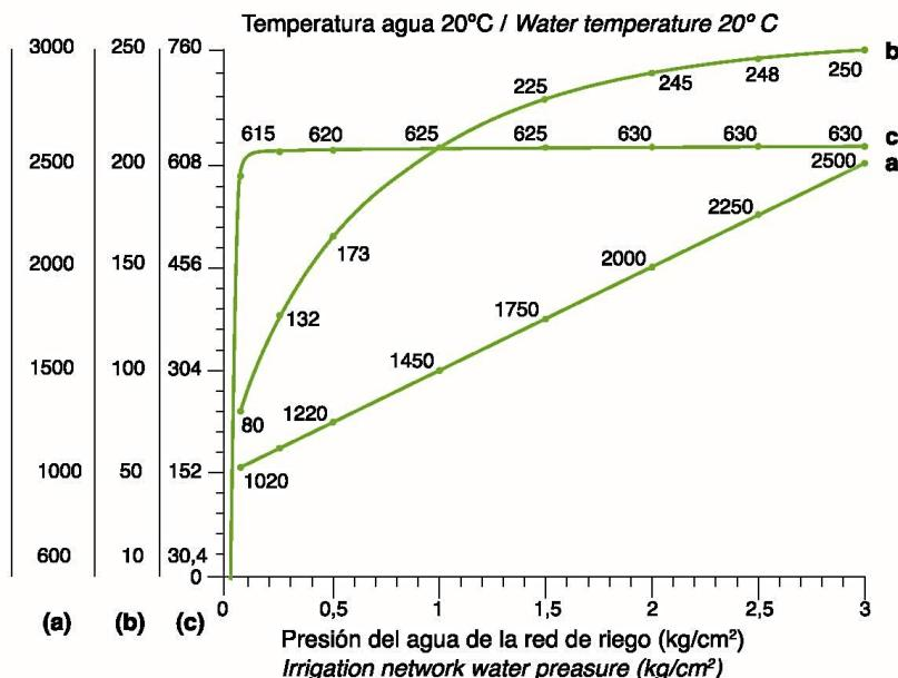
(a) Consumo de agua de riego en l/h. Irrigation water consumption in l/h.
