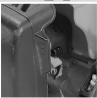
2. Stikalo motorja obrnite v položaj ON.
